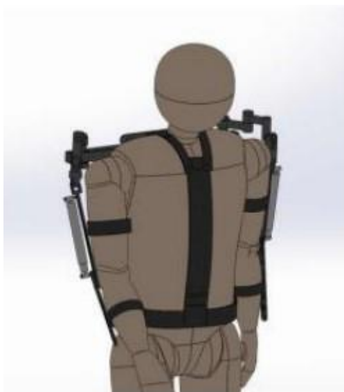
Figura 1: Projeto de exoesqueleto para membros superiores desenvolvido por pesquisadores da UPF. Fonte: Kaiser e Bing (2021).
